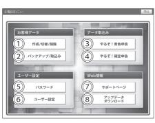
①作成 / 切替 / 削除 (→ P.20) 複数のデータの作成や作成したデータの切替をします。
